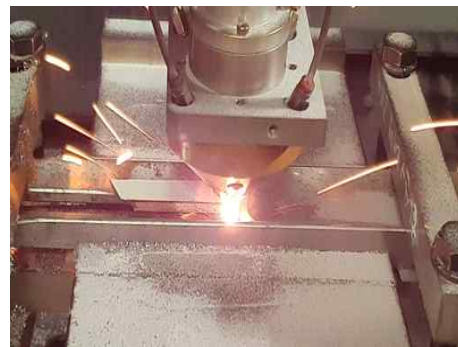
그림 1. 금속적층제조 방식 (L-DED) 및 부품보수 예시
