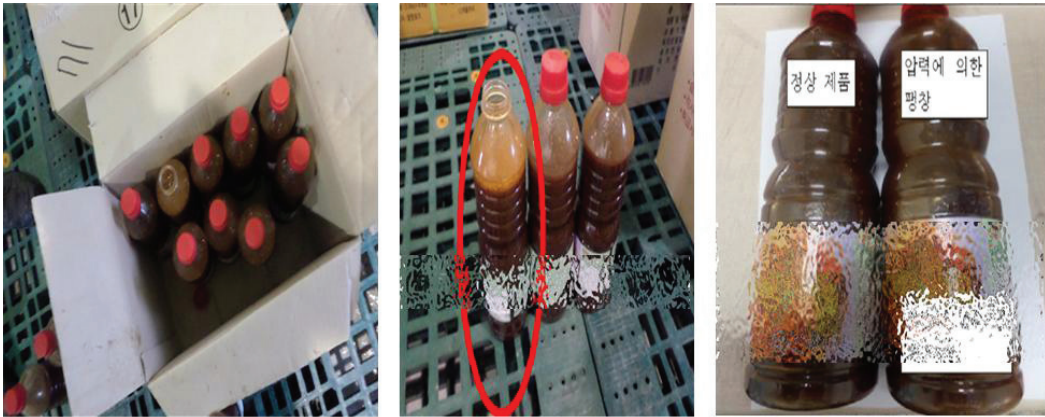
그림 46-5. PET 포장제품의 제품 외관 불량현상
