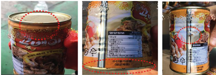
그림 46-1. 골뱅이 통조림 상·하·측면부에 발생한 발청 현상
