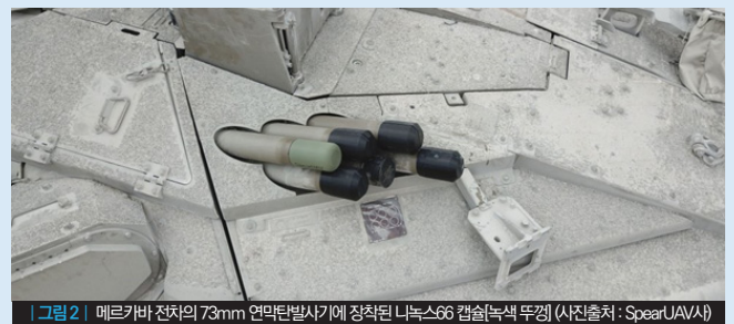
그림 2 | 메르카바 전차의 73mm 연막탄발사기에 장착된 니노스66 캡슐(녹색 두껍) (사진출처 : SpearUAV사)
