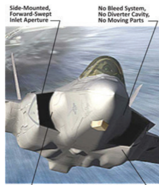
그림 2 F-35 엔진 흡기 시스템 특징
