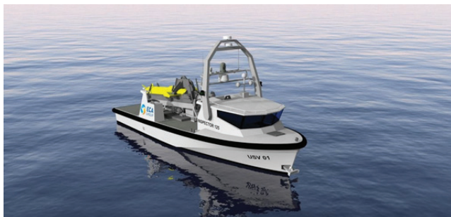
그림 2 인스펙터(Inspector) 125 무인수상정 설계는 종전에 모리사가 SNSM을 위해 개발한 '가라앉지' 않는 선체형태로부터 파생되었다. 이 무인수상정은 T18-M 예인형 음탐기를 운용하는 것으로 설명되어 있다.(ECA 그룹)
