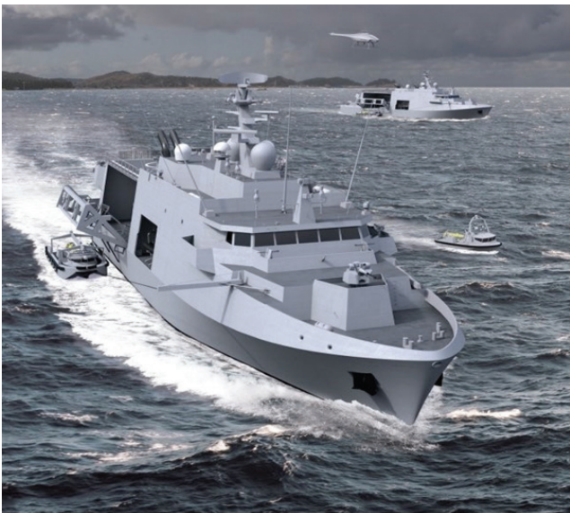
그림 1 벨기에/네덜란드의 미래 MCM 능력은 오프보드 복합체계 도구박스를 운용할 수 있는 모선 설계에 기반을 두게 될 것이다. (네이벌 그룹사)
