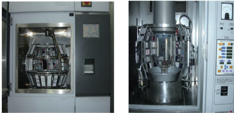
그림 61-1. 카본아크램프 시험기(좌), 제논아크램프 시험기(우)
