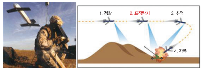
그림 11 Switchblade 발사장면 및 운영개념 출처: U.S. Army to Fly Kamikaze Drones, Defense News (2011. 10.)
