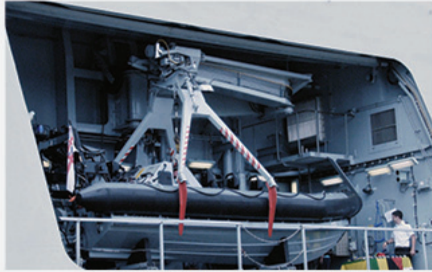
그림 6 Type 45 구축함 다운블리스함의 단정 진·회수체계
