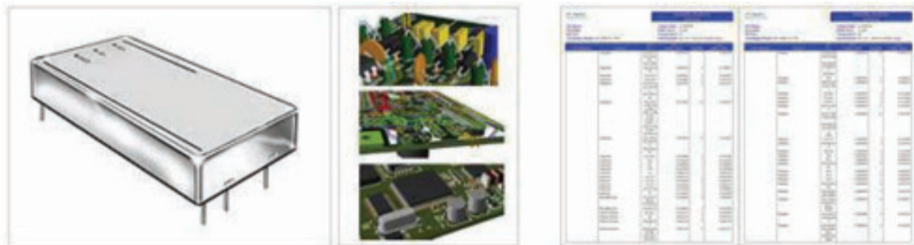
그림 3 ○○체계용 부품 변경(대체 부품 개발)에 따른 수명예측 사례 (왼쪽 : DC-DC 변환기 부품 향상 예시, 오른쪽 : 수명예측 분석결과(기존 대비 1.2배 향상))
