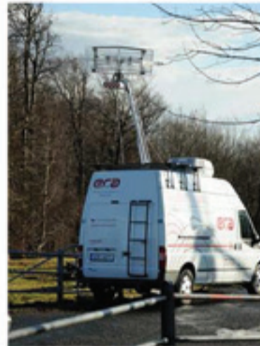
그림 10 SILENT GUARD(체코 ERA): 6-element FM-PCL system
