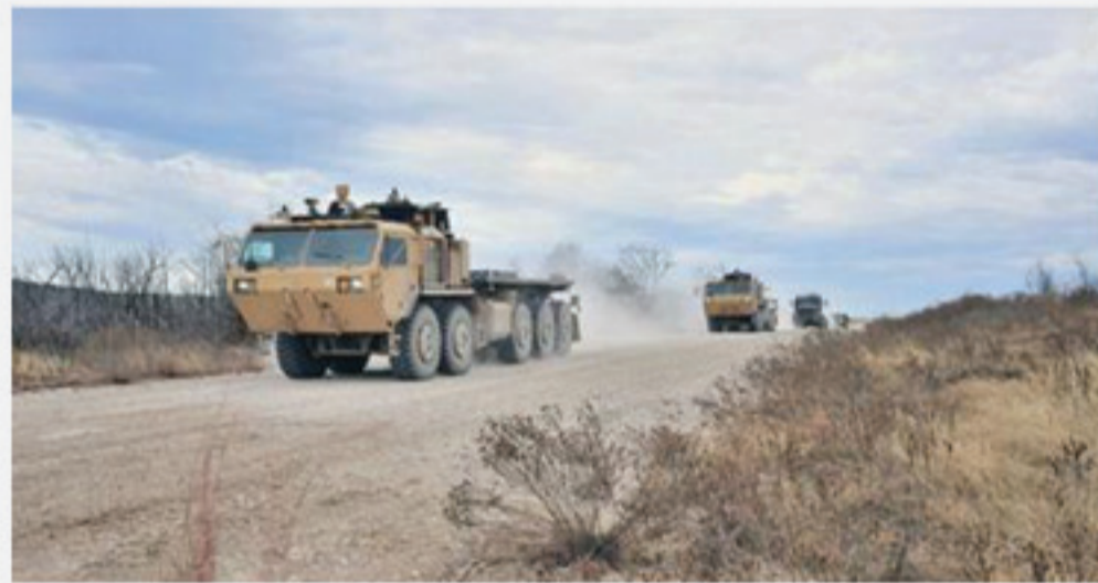
그림 2 자율주행 PLS 및 M915 미 육군 트럭으로 구성된 수송대가 텍사스주 포트 후드 비도시 시험장을 지나는 모습. 경우에 따라 운전석에 병사가 앉기도 하지만 사진 속 차량은 무인으로 운용 중
