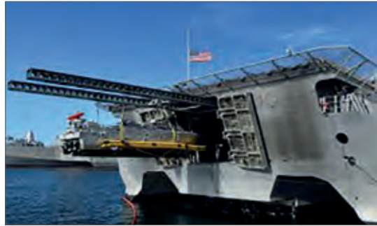
LCS 임무모듈 사업의 일환으로 정박 중 USV를 진·회수 시험중인 인디펜던스함(LCS 2)
