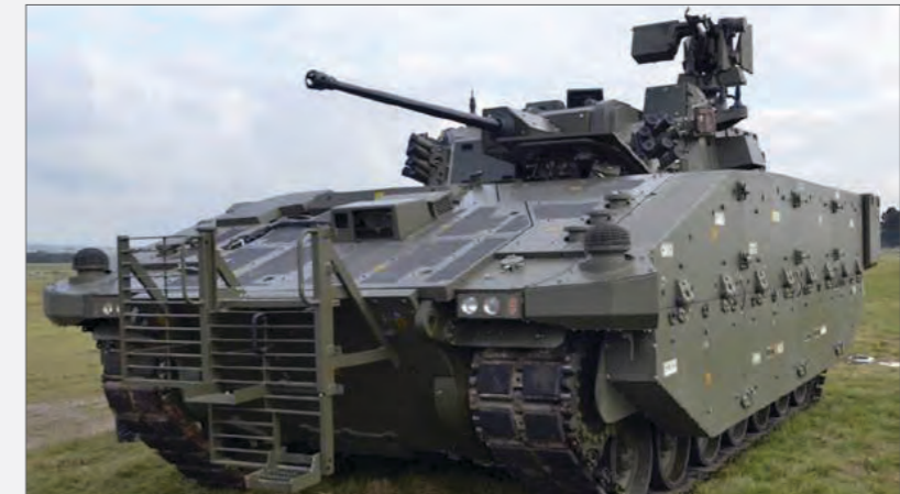
그림 2 장갑차의 중량화 사례(영국의 아약스(Ajax) 계열 AFV는 대체하는 CVR(T) 계열 장갑차보다 크기 및 중량이 약 3배에 달함)
