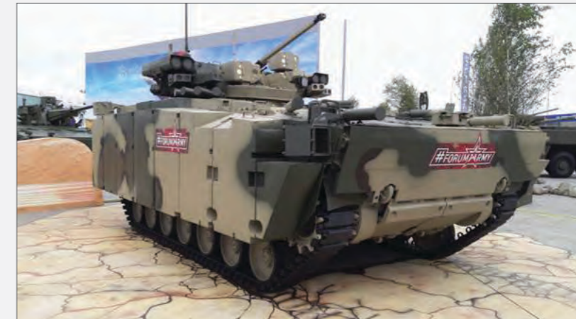
그림 4 다양한 임무체계 대비 방호력이 낮은 사례(에포크 알마티(Epoch-Almaty) 같은 포탑에는 다량의 임무체계가 탑재되며, 대부분의 경우 적 화력에 대한 방호 수단을 충분히 갖추고 있지 않음)
