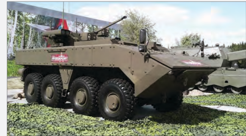
그림 8 장갑차의 대형화 및 중량화 사례(부메랑(Bumerang) 계열 장갑차의 경우 교체 대상인 BTR-80 계열 장갑차보다 크기가 더 커지고 무거워짐)
