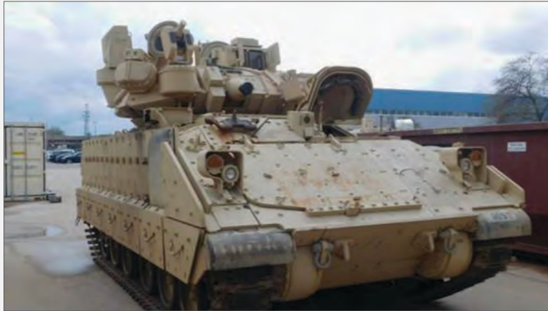
그림 1 차량 임무체계 증가 사례(아이언 피스트 APS를 탑재한 브래들리 보병전투장갑차)
