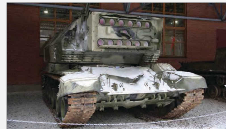
그림 5 레이저 EO 재머 개발 사례(러시아의 1K17 스자티에는 2018년에 페레스베트 체계가 나올 때까지 러시아가 개발한 마지막 이동식 레이저 체계임)
