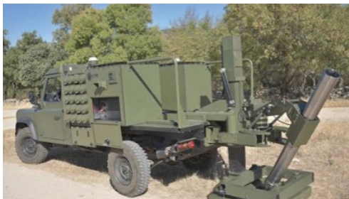
그림 5 NTGS사의 알라크란(Alakran) 120mm 박격포는 4×4 LUV에 쉽게 통합할 수 있도록 설계됐다.
