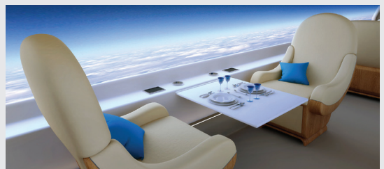
스파이크에어로스페이스의 ‘스파이크 S-512’의 내부 모습. 창문을 없앤 대신 실시간으로 바깥 풍경을 볼 수 있는 대형 디스플레이를 설치했다 (출처: SPIKE AEROSPACE)
