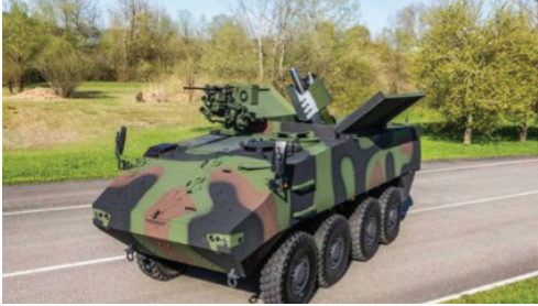
그림 4 스위스 육군은 피라냐 3+에 통합된 루악 디펜스사의 코브라 120mm 활강식 박격포체계 32문을 인수할 예정이다.
