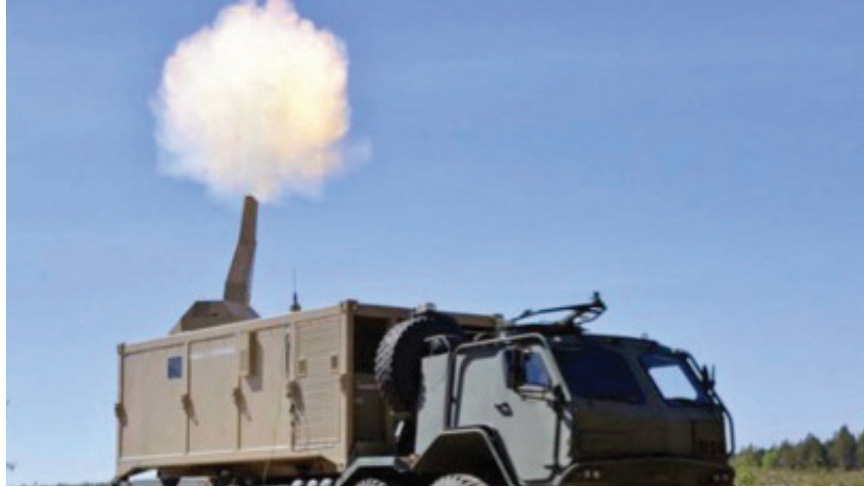
그림 2 파트리아사의 NEMO 컨테이너를 사진에 보이는 시수(Sisu) ETP E13 트럭과 같이 평상형 트럭에 탑재하여 운송하거나, 작전에 투입할 수 있다.
