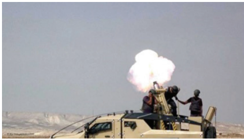
그림 6 엘빗사의 솔탐 스피어 Mk 2 120mm 박격포는 연식주퇴 체계 덕분에 플라산사의 샌드캣 차량과 같은 보다 가벼운 차량에 탑재할 수 있다.
