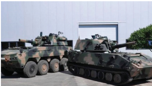
그림 3 HSW사는 폴란드 지상군용으로 8×8 로스막(좌측)에 통합된 RAK 120mm 포탑 박격포 체계 64문을 생산하고 있다.
