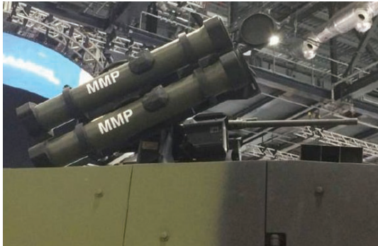
그림 5 원격조종무장장치에 설치된 MBDA사 MMP미사일 발사관
