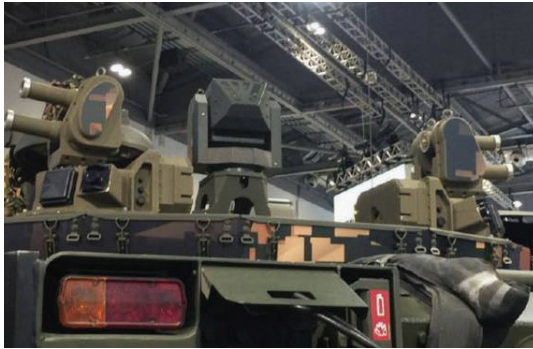
그림 11 이스라엘의 아이언 피스트 하드킬 APS를 장착한 CV9035 IFV
