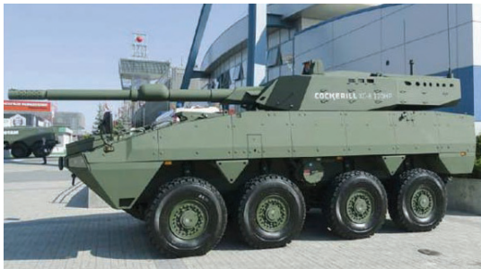
그림 4 코커릴 CT-CV 105HP 2인용 포탑을 탑재한 로소막 8×8 장갑차의 파생형, 빌크 장갑차
