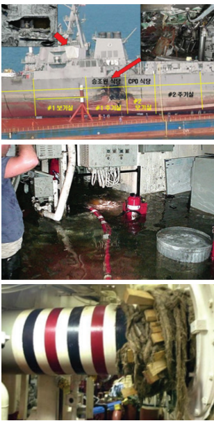
그림 4 미국 콜함의 피격당시 상황 (USS 콜함 손상부위, 주기실 방수작업 결과, 보기실 침수)
