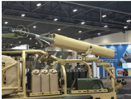
그림 6 슈파캣 LRV 600에 설치된 플레처 로켓체계
