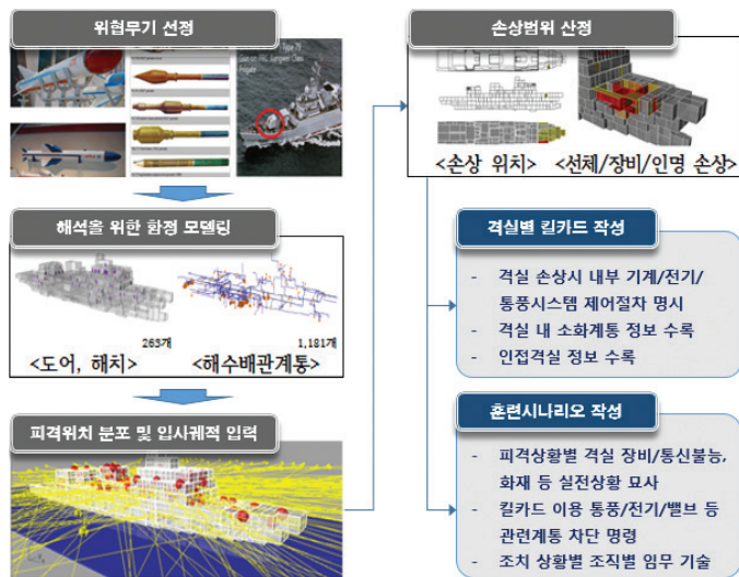
그림 19 간이취약성 해석 프로그램을 이용한 훈련시나리오 작성 절차
