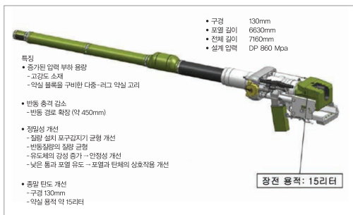
그림 2 라인메탈사가 개발 중인 130mm 활강포 양산 버전
