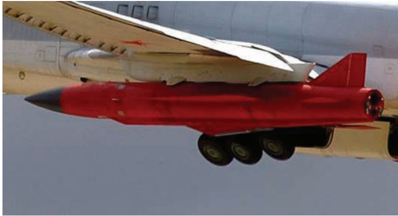
그림 1 Tu-22M3 폭격기에 장착된 Kh-32 대함미사일
