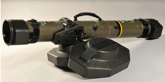
복합재를 사용한 MMP 대전차미사일 발사관 시제 생산품
