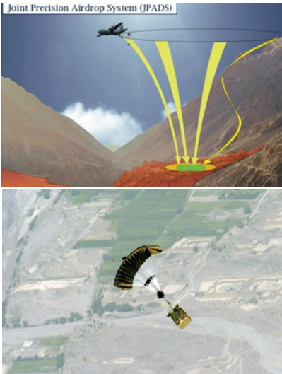
그림 5 JPADS 운용개념 및 활공 모습
