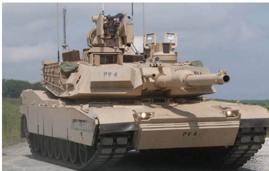
그림 4 프로텍터 체계가 장착된 M1A2 SEPv3
