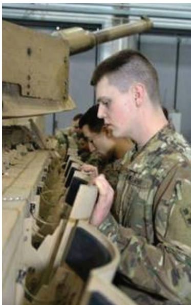
그림 3 측면을 따른 M32 ARAT-2 장갑의 곡선형 타일과 M32 타일과 차량 측면 사이 좌측에 M19 ARAT-1 ERA 상자가 보이는 M1A2 SEPv2
