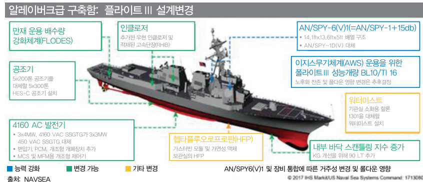
그림 5 DDG 51급 플라이트 III의 설계변경
