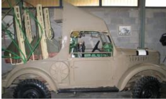
그림 9 | GAZ-69 차량에 탑재된 AT-1 (출처: Wikipedia)
