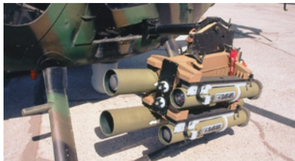
그림 39 | MD530 헬기에 탑재된 SPIKE-LR/ER (출처: Jane's Air-Launched Weapons)
