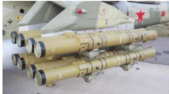
그림 17 | Mi-28 헬기에 탑재된 AT-9 (출처: Jane's Air-Launched Weapons )
