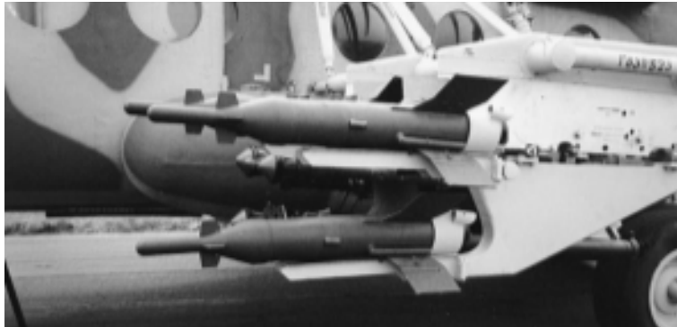
그림 11 | Mi-17MD 헬기에 탑재된 AT-3 (출처: Jane's Air-Launched Weapons )
