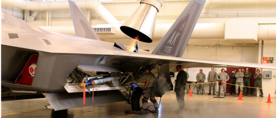
그림 11 | F-22 APGS 시스템 실내 테스트 장면으로 배기구가 동체 위에 존재한다.
