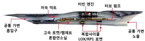
그림 7 | TRRE(Turbo-augmented Rocket-augmented Ram/scramjet Engine)
