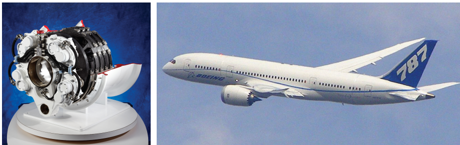
그림 10 | 전기식 브레이크 시스템이 적용된 B787 항공기
