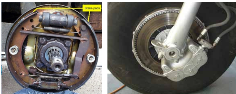
| 그림 6 | Drum Brake(좌)와 Single Disc Brake(우)
