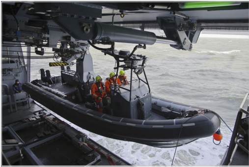
그림 4 | 바덴뷔르템베르크함의 1점식 대빗을 이용해 진수되는 고속단정
