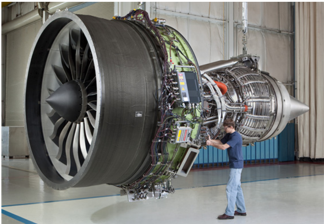
| 그림 1 | 제너럴 일렉트릭(GE)사의 터보팬 엔진 GE90 모델로 항공 역사에서 가장 큰 엔진이며 팬의 직경은 312cm이다.
