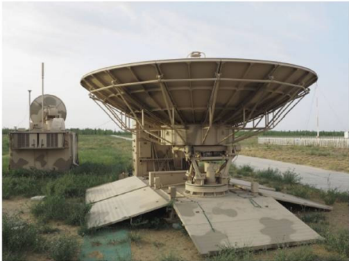
CH-4 UAV 지상통제장비 및 위성통신 배열 안테나
