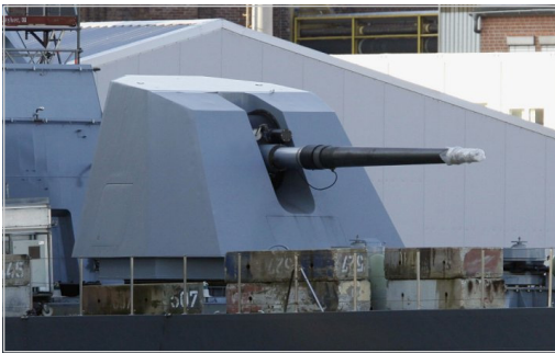
그림 6 | 육상으로 화력지원이 가능한 127/64 경량 함포
