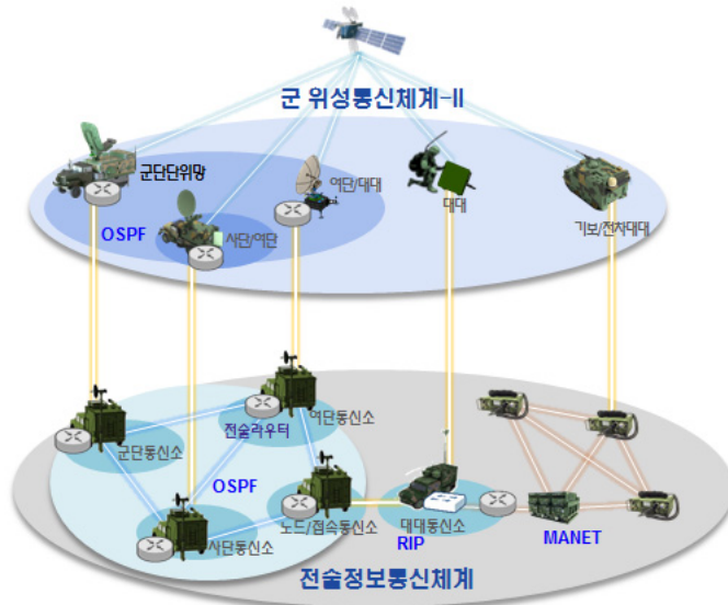
그림 4 | 위성망과 지상망 통합 구조 예상도
