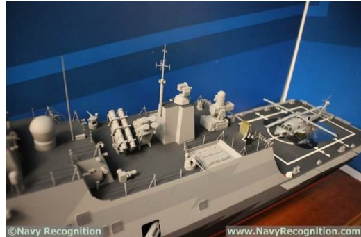
사우디 해군용 MMSC의 무장: 하푼 8발, 16셀 MK41 VLS, SeaRAM
