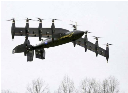
그림 6 | 그리스드라이트닝 시연기의 수직이륙 장면
