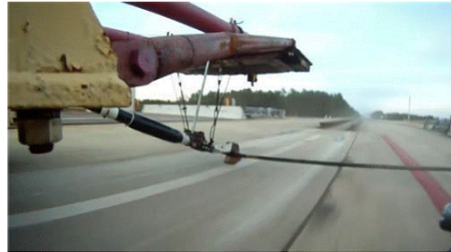
그림 6 | 레이크허스트 시험장에서 F/A-18C/D에 대한 모의하중(100kt) 제동시험
