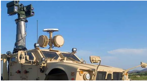
| 그림 1 | MHR에 SABRE를 통합한 통합전장감시 및 C-UAS 체계
