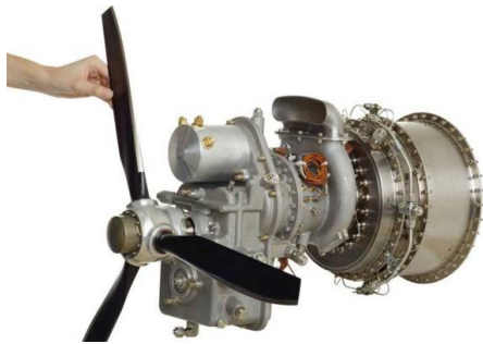
┃ 그림 1 ┃ 50마력급 UAVT 터보프로펠러(UTP50) 엔진
