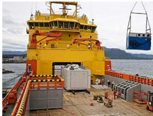
그림 13 | 바이킹레이디의 연료전지 탑재 공간 및 탑재
