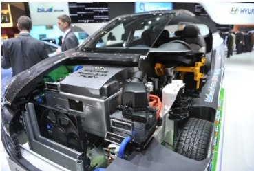
| 그림 2 | PEMFC의 MEA(위), 차량용 PEMFC 시스템(아래)
