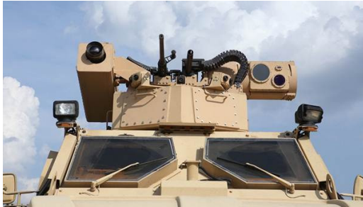
1 그림 2 | RIWP에 SABRE 전자광학장비 및 MHR을 통합한 하드킬 C-UAS 체계
