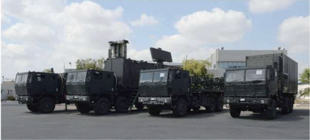
1 그림 21 맨 좌측 차량은 ABISR QR TEL로 컨테이너에 미사일 4발을 탑재하며, 그 옆의 차량은 포대 레이더(사진에서는 이동 중에도 목표물 추적 가능한 IAI/ELTA EL/M 2106 레이더)를 갖춘 지휘차량이다. 세 번째 차량은 미사일 장전차량으로 미사일 발사관 4개를 지지하는 프레임이 보인다. 맨 우측 차량은 포대 기술지원 헬터이다.
