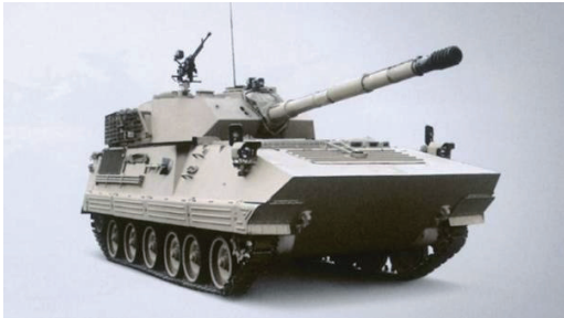
105mm 강선포를 탑재한 3인용 포탑 장착 궤도형 구축전차 ST2
