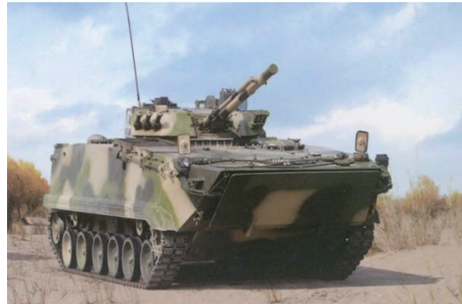
| 그림 1 | 러시아 BMP-3 IFV와 동일한 포탑을 탑재한 VN11(ZBD-04/A)
