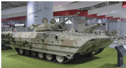
| 그림 2 | 30mm 포, 7.62mm 기관총, 76mm 연막탄발사기, 레드 애로우 73D 대전차유도 무기를 탑재한 노린코 VN12 최신행
