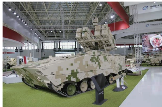
그림 6 | 새로운 궤도형 플랫폼을 기반으로 미사일 8기를 장착한 레드 애로우 10 다목적미사일 체계
