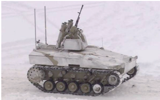
기관총 및 대전차유탄발사기를 탑재한 UGV 소라트니크
