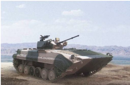
| 그림 4 | 30mm 이중송탄포와 7.62mm 동축기관총, 상부 탑재 레드 애로우 73D ATGW를 장착한 중국제 구형 WZ501 IFV와 기본적으로 동일한 VN6A IFV
