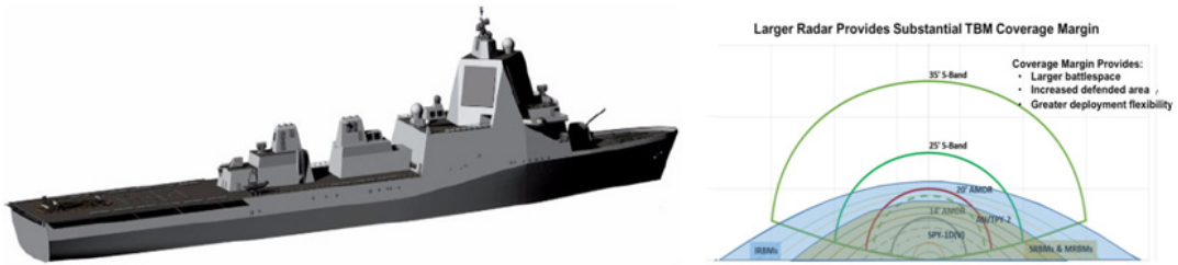
그림 12 | LDP기반 BMD함(좌) 및 S-band 레이더 크기별 TBM 커버리지
