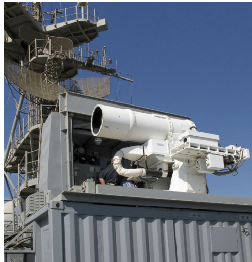
| 그림 4 | KINETO 433 거치대에 장착된 LaWS
