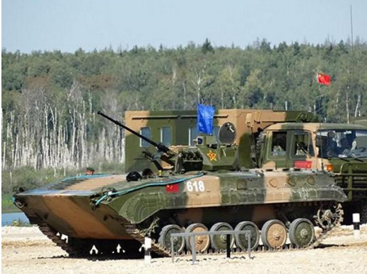
| 그림 3 | WZ-501 성능개량형으로 30mm 포 탑재 신형 포탑을 장착한 ZBD-86A
