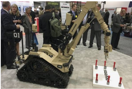
인간 동작을 흉내 내는 팔과 집게를 장착한 해리스사 T7 EOD 로봇
