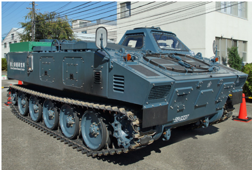
병력수송장갑차 73식 새시를 사용한 하이브리드 추진 실험용 차량
