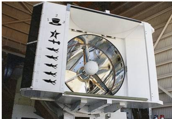
그림 2 | 80년대 MIRACL 화학레이저 시제품
