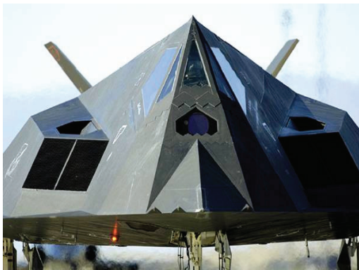
| 그림 2 | F-117의 전면의 스크린이 덮인 엔진 공기 흡입구
