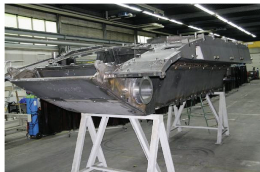
푸마 일체형 용접강 동체(다양한 전장 위협에 대해 뛰어난 방호력을 제공하기 위해 첨단 장갑 패키지를 장착)
