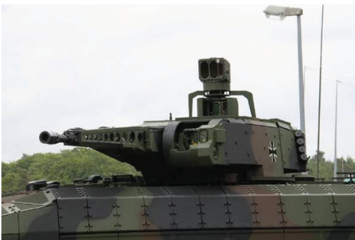
푸마 AIFV의 포탑 근접 사진(무장, 차량장 및 포수용 조준기 탑재, 차량자용 파노라마식 조준기 상부에 MUSS DAS가 탑재)
