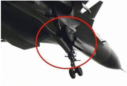
J-15 전투기 전면의 사출기에 의한 이륙이 가능하도록 개조된 이착륙 장치
