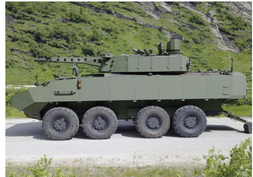
| 그림 2 | 피라냐 IIIc에 설치된 라인메탈 디펜스사 포탑 랜스 MTS (마우저 30mm MK 30-2 이중송탄식 포 및 7.62mm 동축 MG를 장착)
