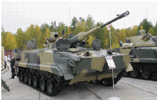
| 그림 5 | 57mm 포 및 7.62mm 동축 MG로 무장한 AU-220M 자동무장장치를 탑재한 러시아 BMP-3 IFV (RCT는 2개의 안정화 구간/열상 조준장치를 구비)
