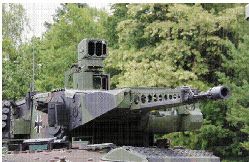
| 그림 3 | 독일 육군의 푸마 AIFV에 설치된 RCT (마우저 30mm MK 30-2 ABM 포탑, 포탑 상부에 탑재된 차량장용 파노라마 조준장치를 비롯하여 여러 방어보조체계를 장착)
