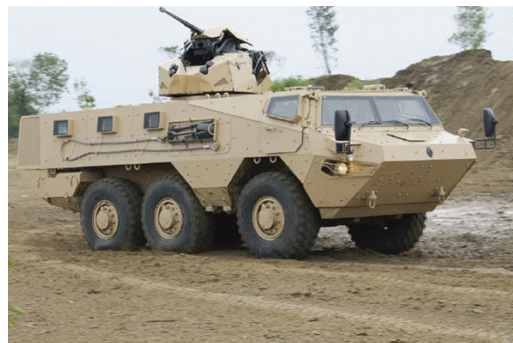
| 그림 4 | 르노트렉스 디펜스사 VAB MK 3 6×6 IFV (오비탈 ATK 아머먼트 시스템스사의 25mm M242 이중송탄식 포 및 7.62mm 동축 MG로 무장한 드넬사 TRT-25를 탑재)
