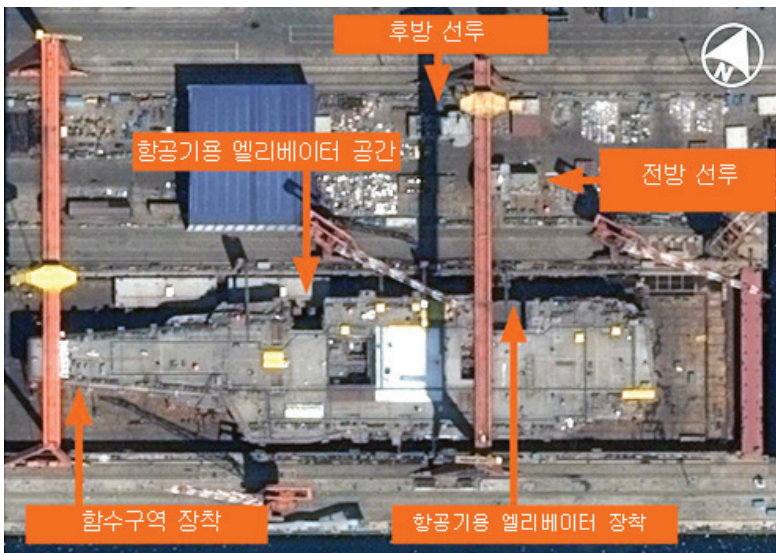
다렌의 건조기에 001A식 선체 (선체는 일부 갑판 부분을 추가용으로 남겨두고 항공기용 엘리베이터 한 대와 선루가 대부분 완료)
