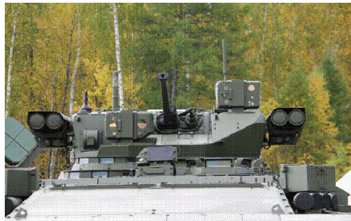
| 그림 6 | 러시아 KBP기기설계국의 에포크 알마티 RCT (30mm 2A42 이중송탄식 포, 7.62mm 동축 MG를 비롯하여 코르넷 레이저유도 미사일 2기가 장전된 발사관으로 무장)
