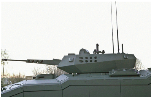
| 그림 7 | FNSS 사분마 시스템레리사의 테베르-30 모듈식 중구경 포탑
