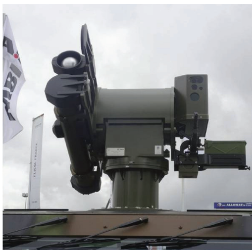
생발 MMP 발사기(좌), 주·야간 센서결합체(우), 7.62mm 기관포(우측 하단)가 장착된 MBDA사의 원격조종 경량 포탑 '임팩트'
