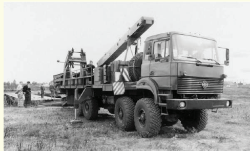
안전화 장치를 지상에 내린 MMK MBS 교량 가설차량
