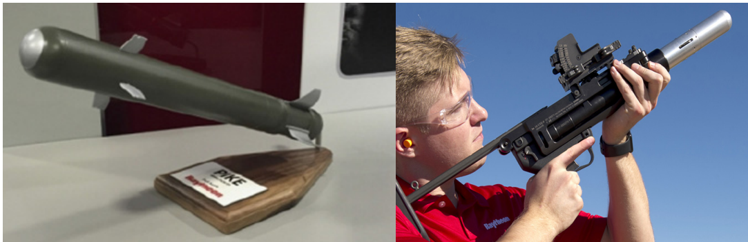
| 그림 4 | 40mm 정밀유도탄약 Pike 모형(좌), 발사 장면(우)
