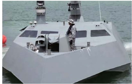
그림 21 폭이 넓고 높이가 낮은 갑판 형상
