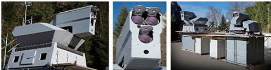
| 그림 11 | 독일 라인메탈사의 50kW급 고출력 광섬유 레이저 무기 (출처: Directed Energy Systems)
