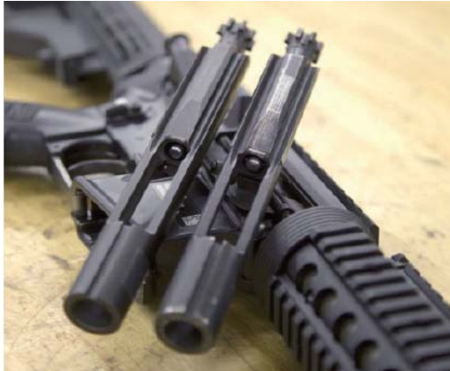
15,000발 사격 후의 표준 CLP 도포 노리쇠(우)와 DSL 적용 노리쇠(좌)
