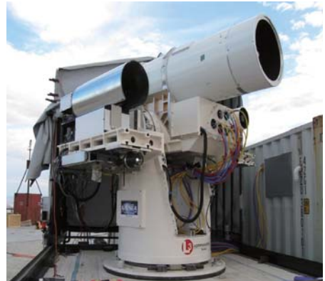
| 그림 12 | 미 해군의 고출력 광섬유 레이저 무기 시스템(LaWS system)
