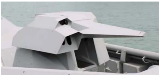
그림 3 | RCS 최소화 설계를 적용한 SMC
