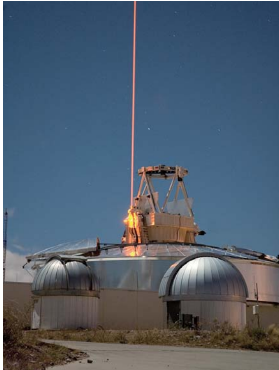
| 그림 3 | AEOS의 레이저 유도별 장치
