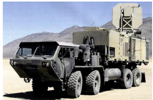
그림 11 비살상 전자파 무기(Active Denial System, ADS)
