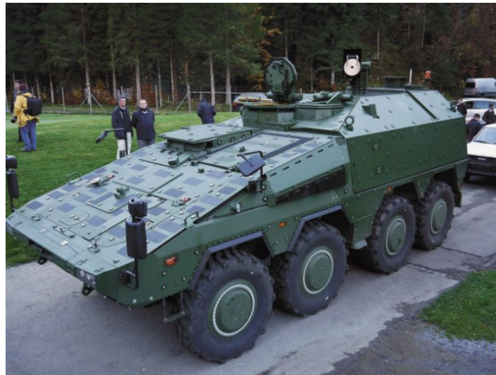
| 그림 | 8×8 GTK Boxer 탑재된 20kW급 레이저 무기
