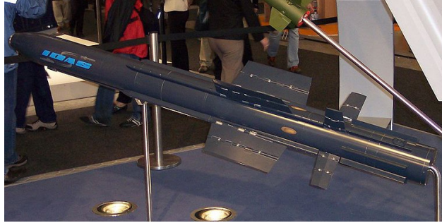
그림 8 | 잠수함 발사 대공 미사일 IDAS
