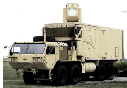
그림 21 보잉사의 트럭 탑재형 이동식레이저무기
