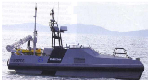
| 그림 6 | K-STER가 달린 ECA사의 INSPECTOR
