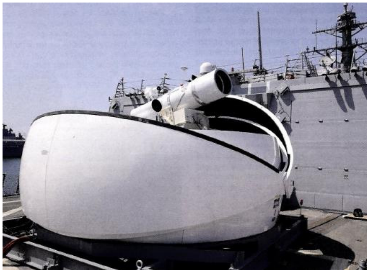
| 그림 4 | LaWs 함상 레이저(LaWs Ship-borne Laser)
