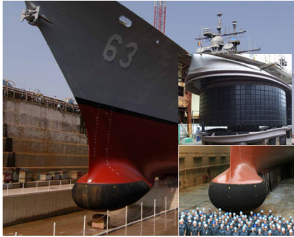
그림 6 | AN/SQS-53 소나돔과 센서배열
