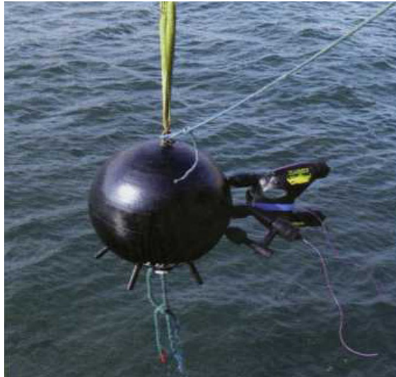
| 그림 8 | 표류 기뢰에 부착된 COBRA
