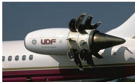
| 그림 8 | GE Open Rotor엔진(UDF) 시험 비행
