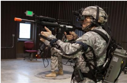
| 그림 2 | 몸에 부착한 센서가 군인의 동작을 포착, 시뮬레이션 속의 아바타를 제어
