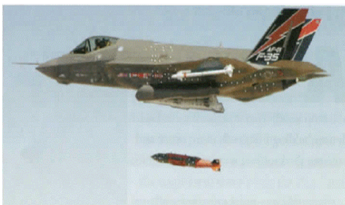
F-35가 발사하는 합동정밀직격탄 (GPS/IMU 유도방식)
