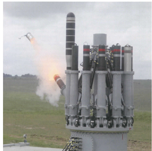
| 그림 7 | Chemring사 CENTURION 기만체계 발사대
