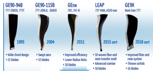
| 그림 24 | Wide Chord Fan 기술 변화 (GE 엔진)
