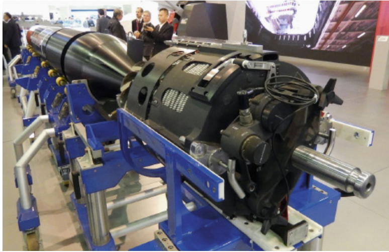
그림 8 | 블랙사크 개량 어뢰(재충전 가능한 배터리 형상 버전에 광섬유 처리장치가 설치되어 있다.)
