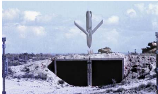
그림 72 AGM-158 JASSM 신뢰도 시험
