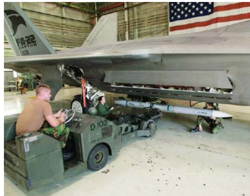
그림 61 전투기에 장착 중인 AIM-120D
