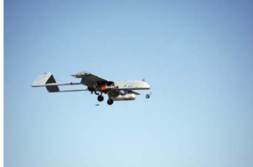
그림 38 새도 호크 소형 정밀유도무기를 장착하고 비행하는 RQ-7B 새도 무인기
