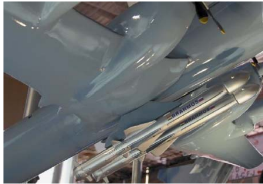
그림 84 인도의 해군 II-38SD의 모델 (브라모스 미사일 2발을 장착)
