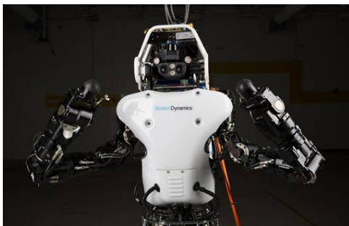
그림 21 아틀라스 로봇은 배터리 운용과 관련하여 전력 효율성 개선 목적으로 재설계되었다.
