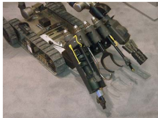
그림 41 도구 5종을 장착할 수 있으며, 도구 자동교체가 가능한 툴체인저
