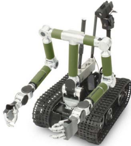
그림 21 양손 조작 가능한 아드로이트 머니플레이터 팔
