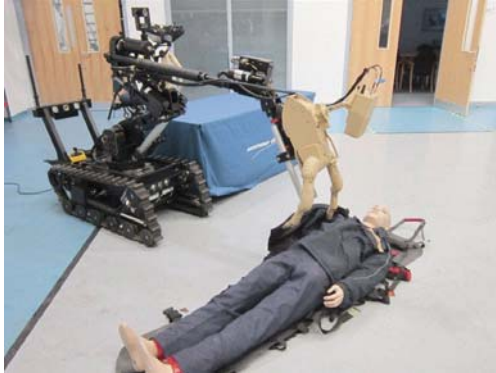
그림 31 탁월한 손재주와 정밀조작 작업에 필요한 원근감을 제공하는 DADM
