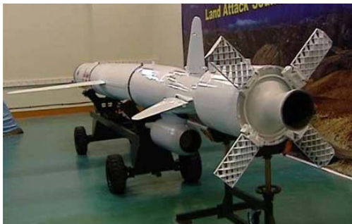
1 그림 61 소우마르의 접이식 격자모양 조종용 꼬리날개
