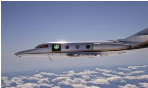
| 그림 3 | ABC (Aero-Adaptive/Aero-Optic Beam Control) 레이저를 장착한 록히드마틴사의 팰콘(Falcon) 10 시제기
