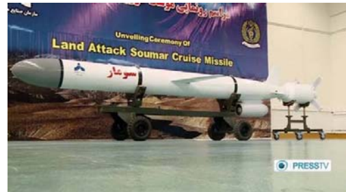
그림 4 | 소우마르의 공기흡입형 엔진은 동체 뒤쪽 아래에 설치되며, 후미에는 고체연료 부스터가 부착된다.
