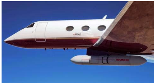
그림 6 | 질화갈륨 부품을 이용한 차세대 재머포드(jammer pod)
