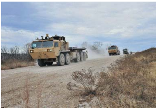
그림 11 록히드마틴사는 AMAS 사업의 일환으로 M915 트럭에 무인임무 모듈을 통합
