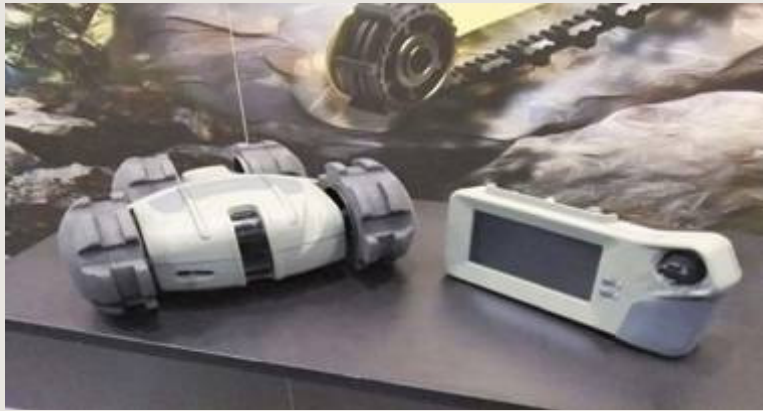
그림 7-9 로보팀사 투척형 로봇 아이리스
