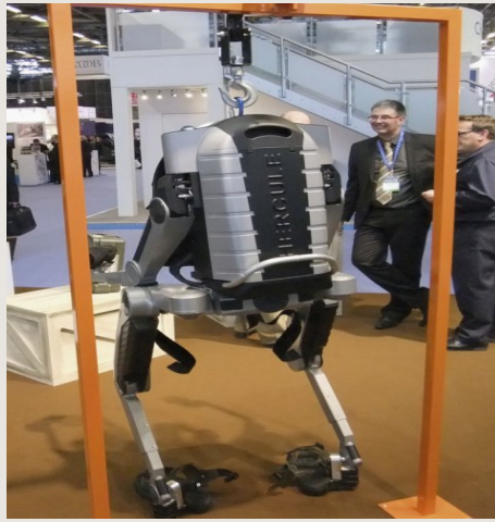
그림 8-14 모터와 배터리를 백팩에 내장하고 팔을 장착한 신형 에르쿨 후면
