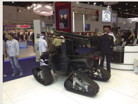
그림 12-12 RPG 발사기 4정과 Cal .50 기관총을 장착한 어스사 무인지상차량
