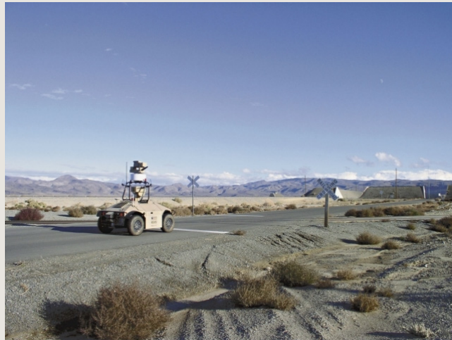
그림 2-42 MDARS 탑재한 군사 기지 방호용 무인지상차량 폴라리스
