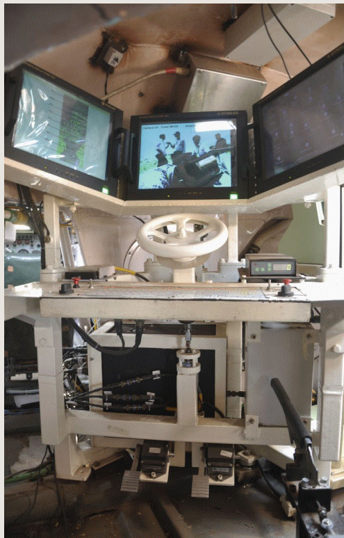
그림 10-9 문트라-B 지휘차량의 운용자 제어장치
