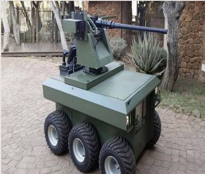
그림 12-15 12.7mm 기관총을 장착한 무인지상차량 패스파인더
