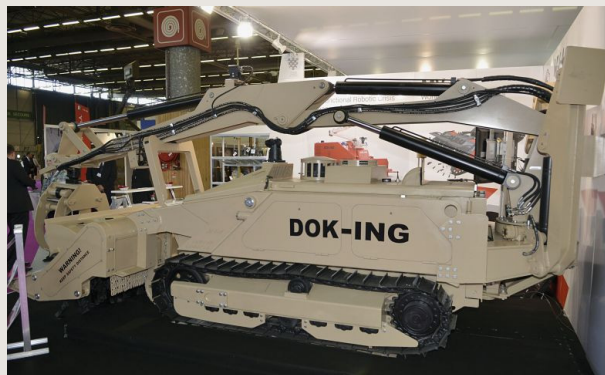
그림 12-2 원격제어 궤도형 지뢰제거 체계 M160 MV4
