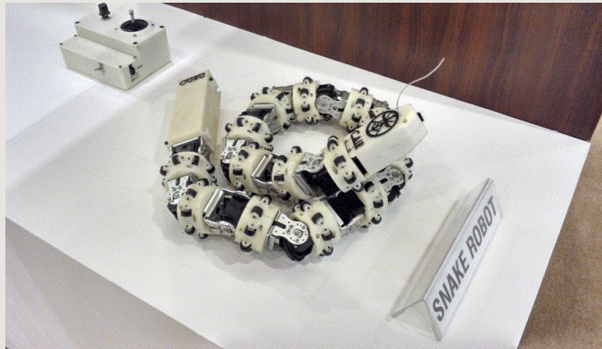
그림 10-5 배관 검사나 재난구조 상황에서 운용하도록 설계한 뱀 로봇
