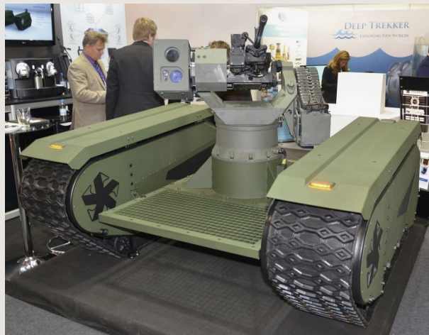
그림 12-10 몇 가지 무장 또는 군수 모듈을 장착할 수 있는 밀렘사 UGV 타입 1
