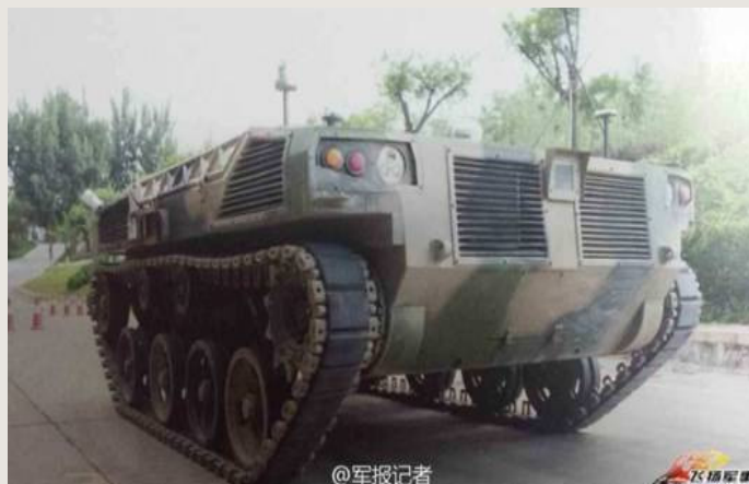
그림 4-6 페러세일링 자율주행로봇: 현재까지 정확히 식별되지 않은 이 장갑 전투차량은 경량, 얇은 장갑, 좁은 궤도 등을 고려할 때, 원래 공수(낙하산 투하) 작전용으로 설계된 것으로 보인다. 상응하는 유인 장갑전투차량과 같이 전투지역에 직접 낙하산으로 투하할 수 있다. 차량은 보통 낙하산으로 투하되며, 승무원들은 별도 낙하산으로 강하한다. 이는 탑승상태에서 지상으로 투하할 때 일반적으로 입게 되는 부상을 방지하기 위해서이다.
