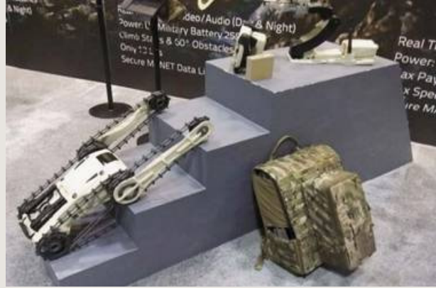
그림 7-7 로봇팀사 무인지상차량 MTGR과 제어기
