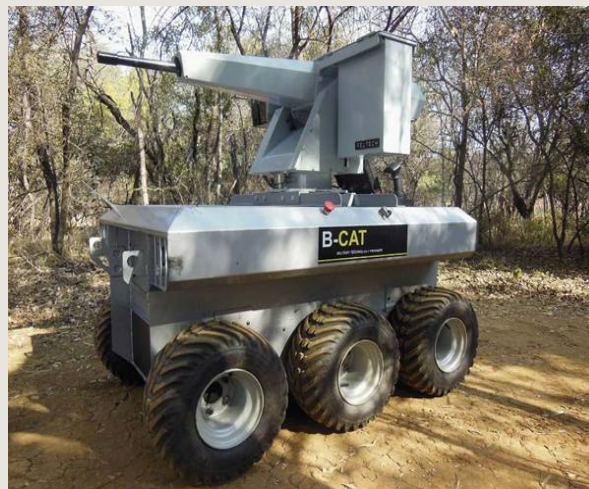
그림 12-16 20mm포를 장착한 무인지상차량 패스파인더
