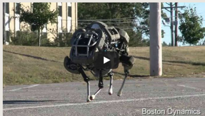
그림 2-5 시속 26km로 주행가능한 로봇 와일드캣
