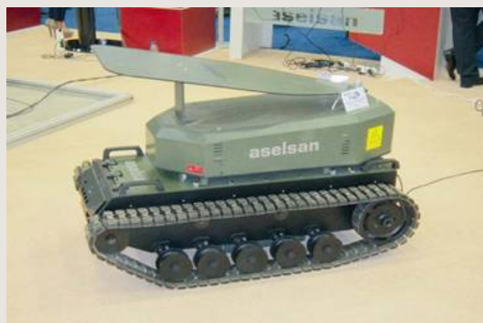
그림 11-6 급조폭발물 탐지 및 재밍장치를 결합한 아셀산사 무인지상차량 카플란
