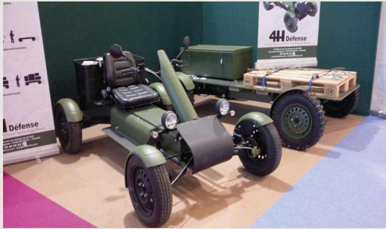
그림 8-6 무인지상차량 익스플로라(좌측: 유인조종이 가능한 형상, 우측: 화물 적재형)
