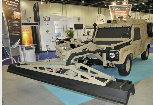
그림 5-5 지면투과레이더와 길이 조절 가능한 팔을 장착한 패스 파인더
