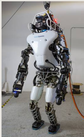
그림 2-16 전도(顛倒)방지장치를 장착한 신형 아틀라스
