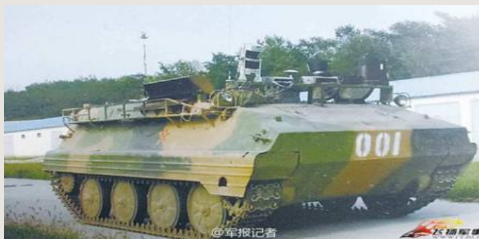
그림 4-3 자율 무인지상차량 ZSD-63: ZSD-63은 중국 최초의 장갑전투차량 중 하나로 1960년대에 운용을 시작했으며, 구급·정찰·박격포·병력수송·대전차용 등 다양한 버전이 있다. 중국은 ZSD-63을 자율주행이 가능하도록 개조하였는데, 비디오 카메라와 라이더(추정) 및 주행용 레이더 등 3개 센서가 전면에 설치되어 있다.
