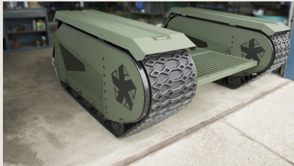
그림 12-9 밀렘사 하이브리드 궤도형 무인지상차량 UGV 타입 1
