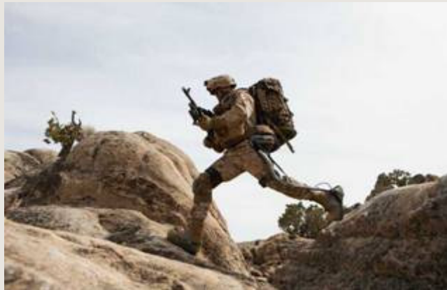
그림 2-51 병사 어깨와 다리에 가해지는 하중을 경감시키도록 설계된 헬크 티타늄 다리
