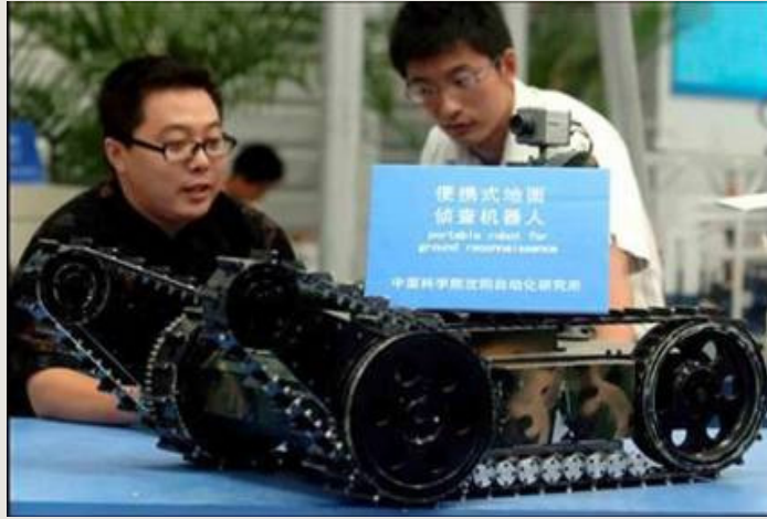
그림 4-8 휴대형 중국 로봇: 지상 정찰 목적으로 제작한 휴대형 로봇이 2006년 8월 29일 중국 쉐양에서 개최된 제5차 중국 국제장비제작전시회에 전시되었다. 이 로봇은 아이로봇사 팩봇의 형상을 닮았다. 운용자는 데이터 링크를 통해 원격 운용한다. 운용자는 위험거리 밖에 위치해 있을 수 있다.
