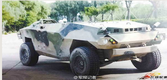
그림 4-4 무인차량 QLL-05: 이 4×4 자율 장갑전투차량은 무인운용을 위해 많이 개조했다. 탑승실과 운전실 대부분을 제거하여, 무게를 줄이고 센서 시야를 개선하였다. 센서는 범퍼와 보통 뒷좌석이 위치하던 곳에 설치하였다. 이 로봇은 QLL-05 정찰장갑차로 운용착수된 것으로 알려져 있다.
