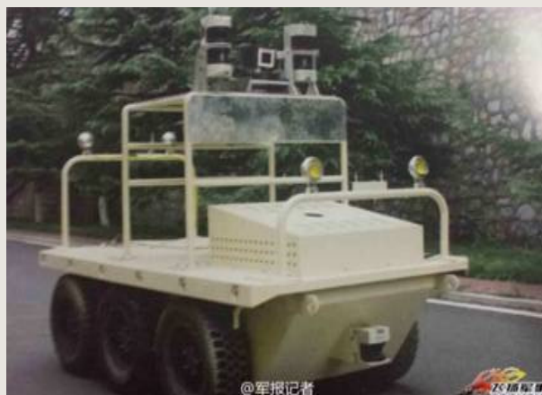
그림 4-7 전지형 로봇: 중국 공중기동 보병과 특수부대는 연습 중에 가벼우나 빠른 수송모드 및 화력지원기동을 위한 편리한 수단으로 ATV를 운용하였다. ATV는 현재 자율주행을 학습하고 있다.
