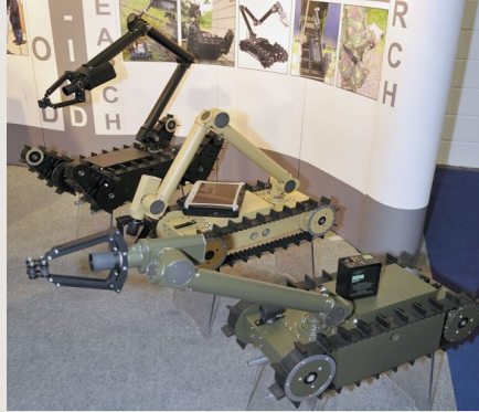
그림 5-8 1, 2, 3 관절 장착(우측부터)한 무인지상차량 퍼스트 리스폰더
