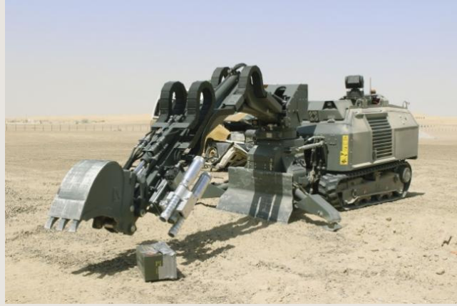
그림 9-2 원격조종 대인지뢰제거장비 마이크로 마인울프 MW50
