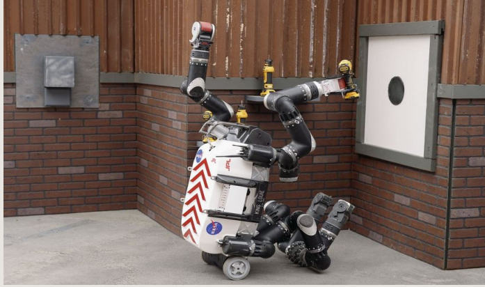
그림 2-21 안정된 자세로 벽 뚫기 과제를 수행하는 로보시미안팀 로보시미안
