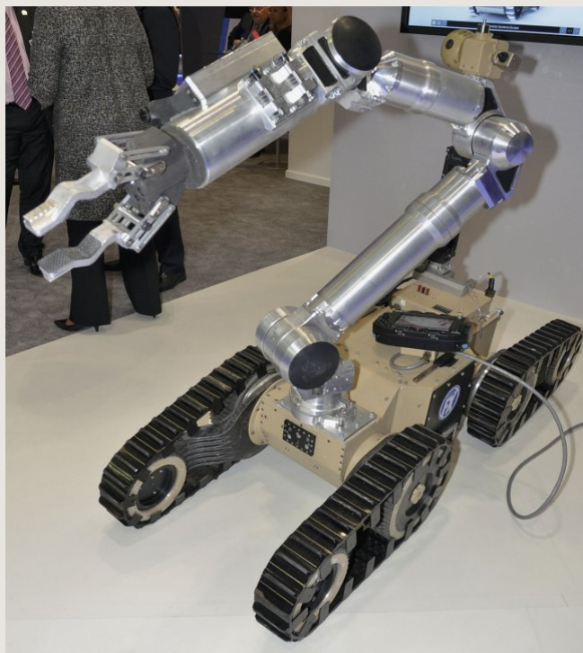
그림 2-49 리모텍사 폭발물처리용 차세대 안드로스 로봇
