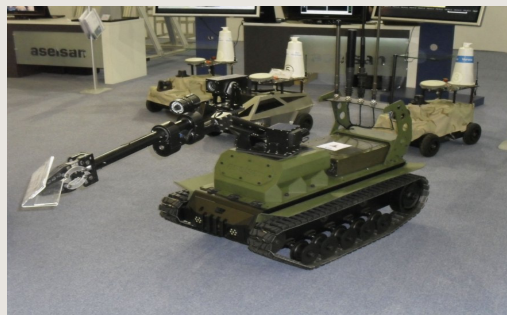
그림 11-2 급조폭발물 대응 형상에 탑재된 아셀산사 키르피 급조폭발물 재머 체계
