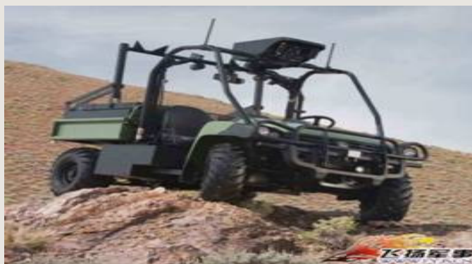
그림 4-2 자율주행 전지형주행차량: 자율주행이 가능하게 장비를 탑재하고 있다. 센서 박스가 가급적 넓은 시야를 확보할 수 있도록 높게 설치되어 있다.
