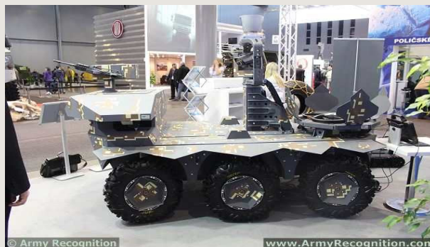
그림 12-6 모듈식 차륜형 다목적 무인지상차량 타로스 6×6 V2
