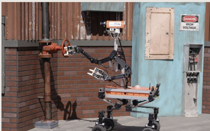
그림 2-23 밸브 과제를 수행하는 님브로 레스큐팀 모마로 로봇
