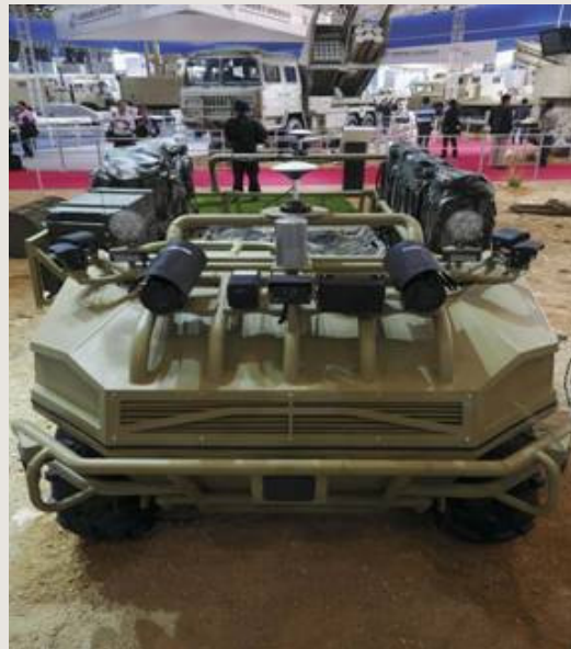
그림 4-13 원래 기능은 장비·무기·소모품 운반이지만 병력 8명도 수송 가능한 CTSUMP
