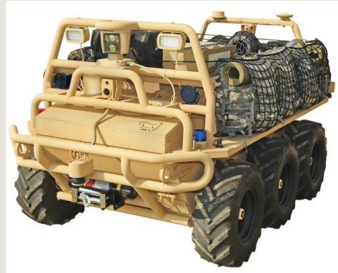
그림 2-28 분대임무지원용 무인지상차량 SMSS
