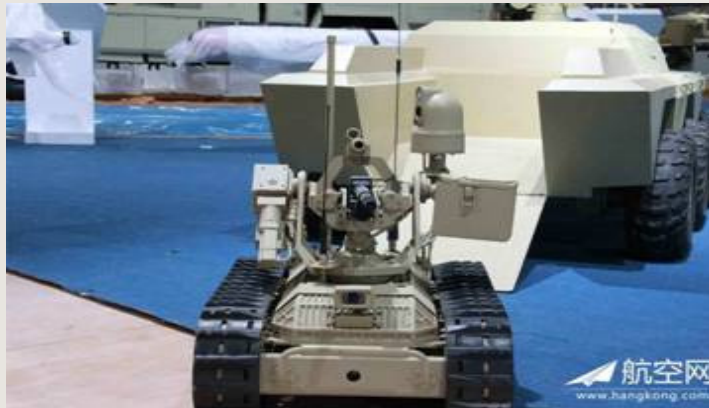
그림 4-10 수출 가능한 중국 최초의 무장 무인지상차량 샤프 클로 1: 샤프 클로 1 로봇은 모션인 샤프 클로 2에 실려 있다 밖으로 나오며, 기관총과 여러 개의 센서를 갖추고 주변을 돌아다니며 스스로 표적을 찾는다. 그러나 유사한 미국 마르스 로봇과 마찬가지로 무기 발사 여부는 인간이 결정한다. 샤프 클로 1은 모션인 샤프 클로 2에서 자력으로 나온다. 샤프 클로 2에 샤프 클로 1을 탑재하여 운용범위를 확대하는 것 외에도, 샤프 클로 2의 고품질 센서를 이용해 기관총 발사를 책임지는 인간 통제자와의 데이터 통신 링크를 강화할 수 있다.
