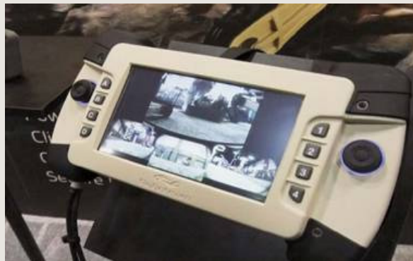
그림 7-8 로봇팀사 무인지상차량 MTGR 및 아이리스용 ROCU
