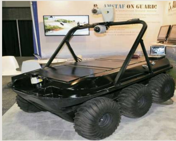
그림 7-5 6륜 및 8륜 형상으로 가용한 무인지상차량 암스타프
