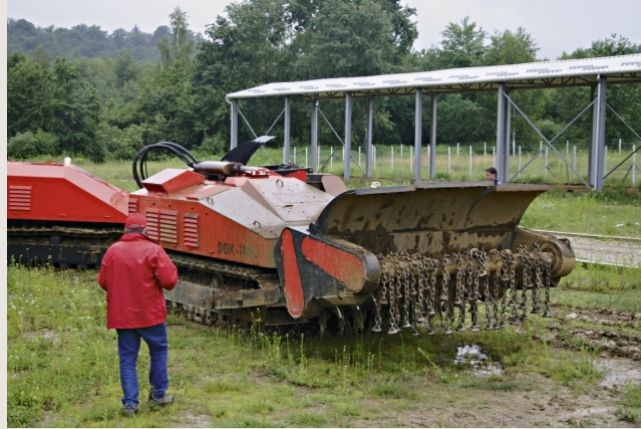
그림 12-3 대전차지뢰 제거 전용 궤도형 원격제어체계 MV-10
