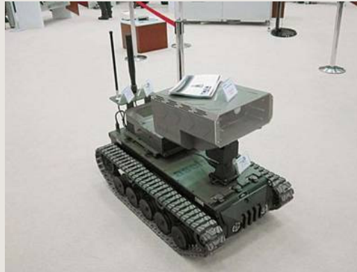
그림 11-5 최대 15m 작동되는 레이저 무력화체계를 통합한 무인지상차량 카플란
