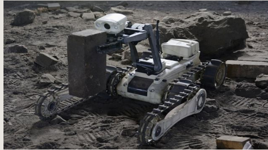
그림 12-7 이스라엘 로보팀사 경찰 로봇 MTGR
