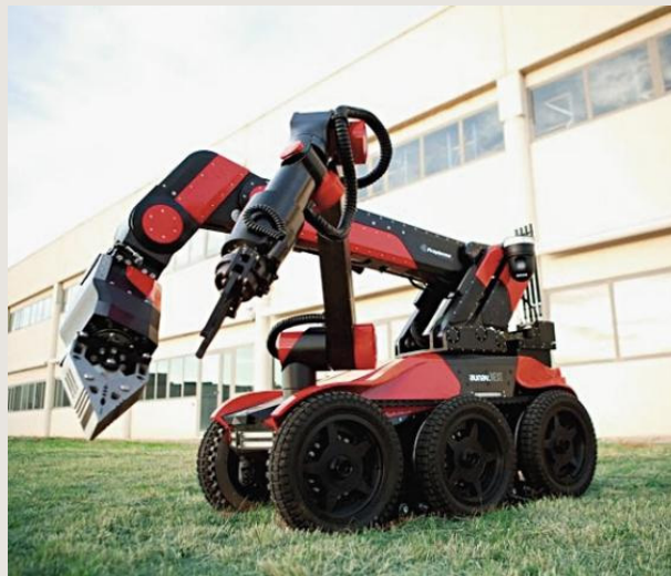
그림 12-1 프로이텍사사 폭발물해체 로봇 아우나브
