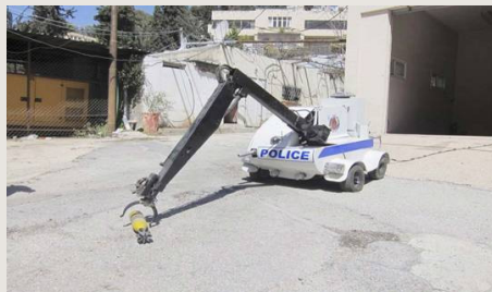
그림 12-14 팔레스타인 폭발물처리 로봇
