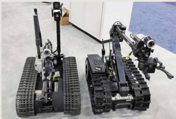
그림 2-47 키네틱사의 원래 탈런(좌측)과 크기가 작고 가벼운 탈런 4(우측)
