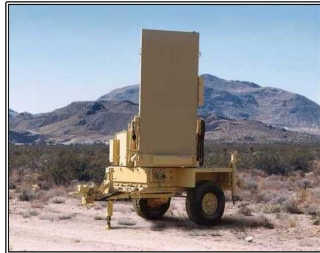
그림. AN/TPQ-36(V)10 FIREFINDER 레이더
