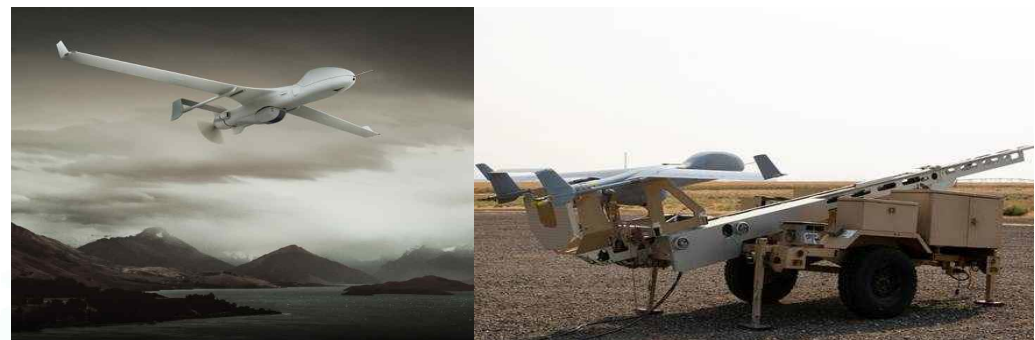
Integrator Extended Range UAV 형상(좌) 및 발사체계(우)
