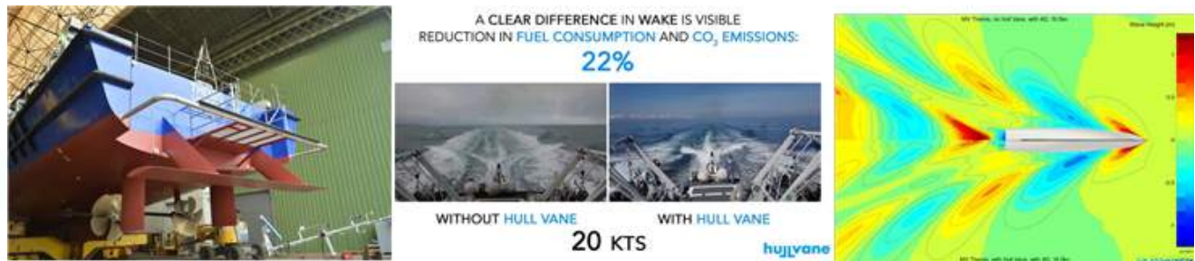
OPV 함미부에 설치된 선체 베인(좌)과 20kt에서 선체 베인 유무에 따른 항적 차이(중) 및 CFD에 의한 분석
