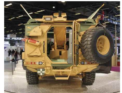
Alkar 박격포체계의 차량장착형태 개념도(좌)와 Alkar 박격포체계를 장착한 BMC Vuran 다목적장갑차 후면(우)
