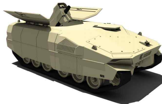
Alkar 박격포체계의 차량장착형태 개념도(좌)와 Alkar 박격포체계를 장착한 BMC Vuran 다목적장갑차 후면(우)
