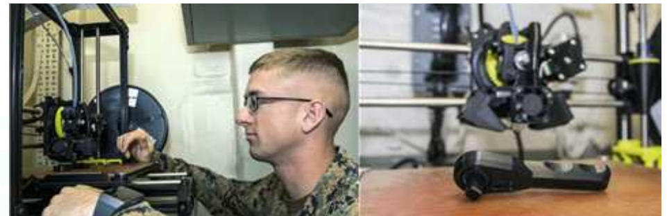
새커거위아함(T-AKE 2)에 설치된 3D 프린터(좌)와 3차원으로 프린트된 래칫
