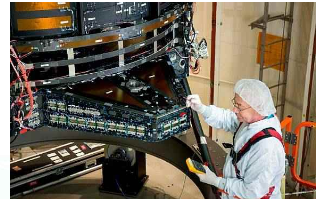
WFIRST를 위한 단파장 적외선 전자광학 센서 조립
