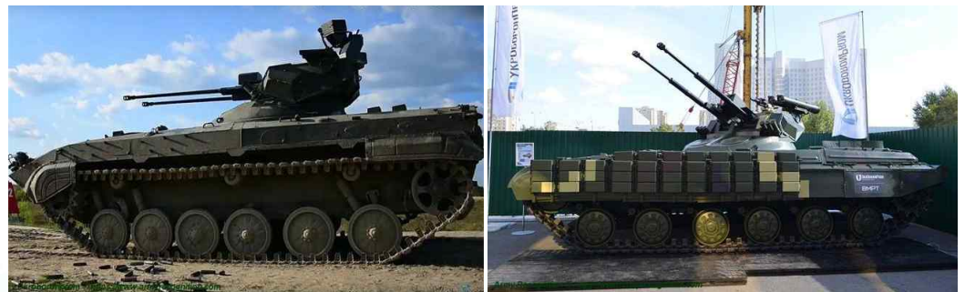
러시아산 BMP-1 차체에 장착된 듀플리트 전투모듈(좌)과 우크라이나산 BMPT 스트라시(우)
