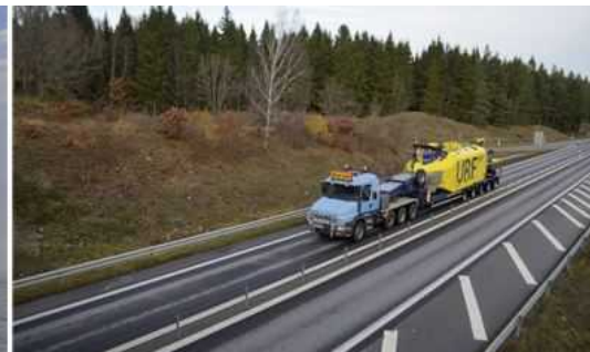
잠수함 구조를 위해 함미의 A-프레임을 이용하여 해상으로 투입되는 SRV(좌)와 차량과 항공기로 이동하고 있는 SRV
