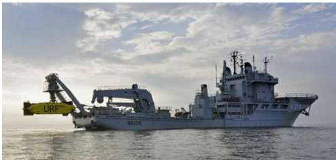
잠수함 구조를 위해 함미의 A-프레임을 이용하여 해상으로 투입되는 SRV(좌)와 차량과 항공기로 이동하고 있는 SRV
