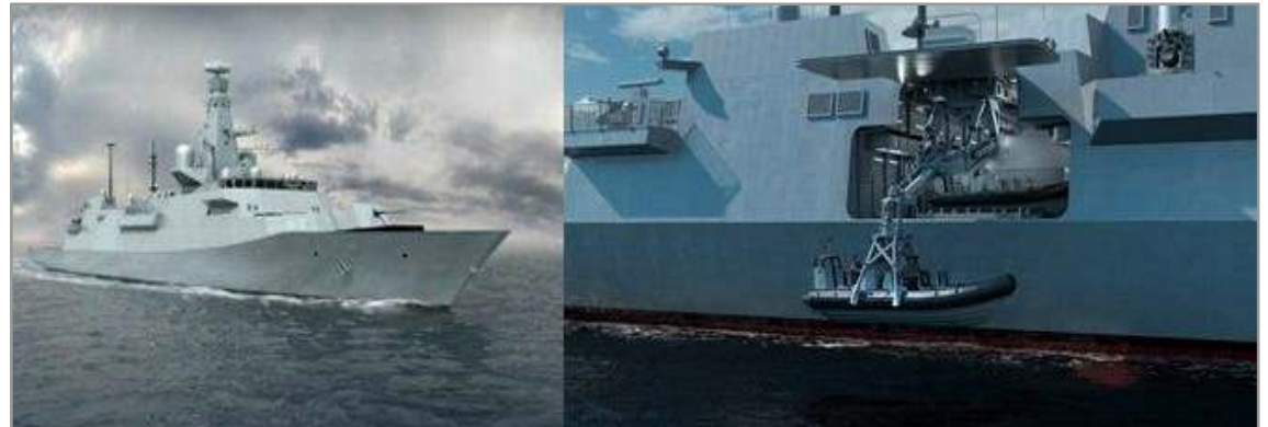
Type 26 호위함의 컴퓨터 이미지(좌)와 임무구획 취급체계를 이용한 단정 진수
