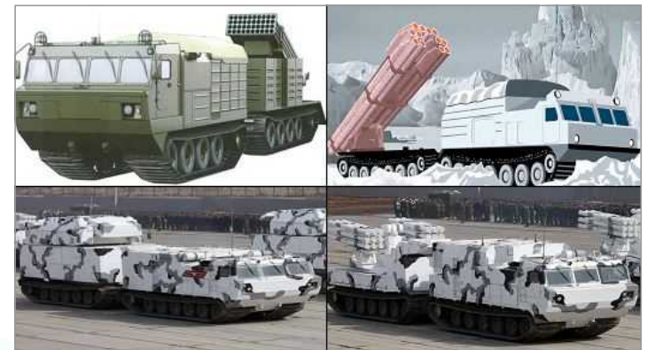
(상) MLRS 탑재 전지형 차량 이미지, 그래드 탑재형(좌)/스메르치 탑재형(우) (하) DT-30PM을 토대로 제작된 TOR-M2DT(좌)와 판치르-SA(우) 체계
