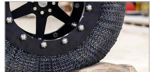
니켈-티타늄 형상기억합금을 이용한 신형 타이어
