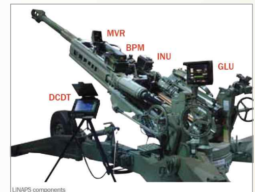
LINAPS components 리납스 체계가 장착된 견인포
