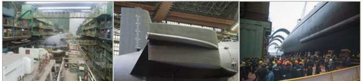
건조 중인 크냐츠 블라드미르함의 함수부(좌측), 선배열음탐기 케이블이 전개되는 함미수평타(중앙) 선체에 부착된 FAS
