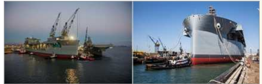
주수를 통해 건선거 방식으로 진수되는 ESB 4(왼쪽)와 진수 후의 모습
