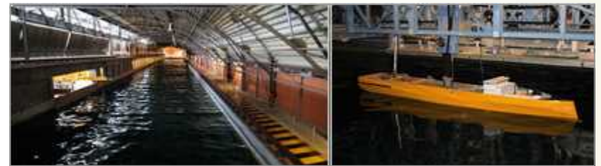
노르망디에 있는 DGA의 견인수조 B600(좌 사진)과 시험 중인 FTI 모형
