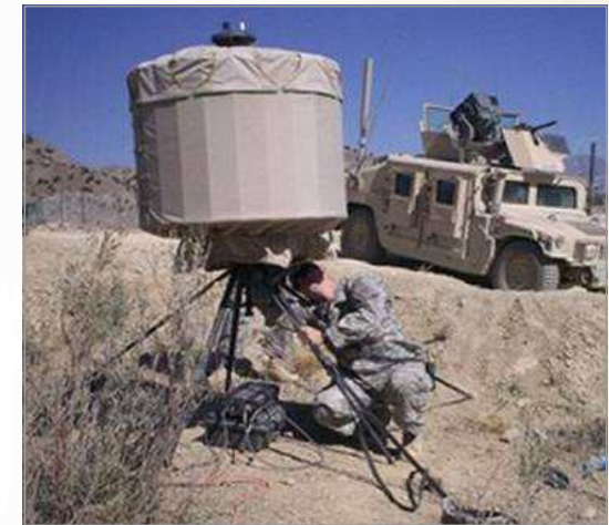
경량 대박격포 레이더 설치모습
