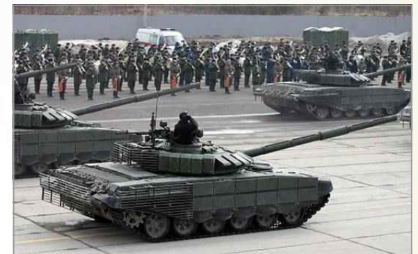
새로운 버전의 T-72B3 MBT (포탑 각 측면에 ERA가 설치되고 후방에 철망형 장갑 장착)
