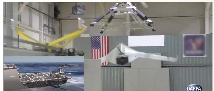
Fury 무인기의 회수시험 중인 SideArm 및 함상 운용개념도(왼쪽 하단)
