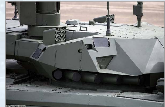
러시아제 주력전차 T-14 아르마타 포탑에 장착된 능동방호장치 아프가니트
