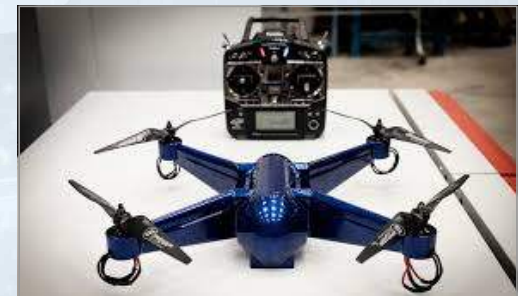
전자장비 내장 3D 프린팅 무인기
