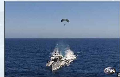
대잠전용 무인정에 TALONS 탑재 시험
